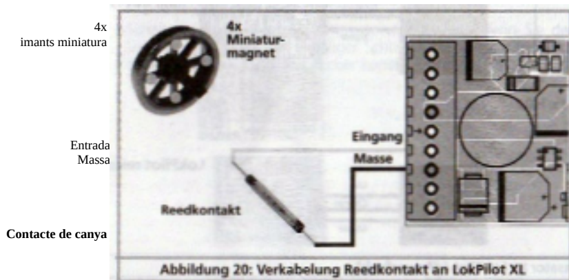
Figura 20: Cablejat del contacte de canya al LokPilot XL
